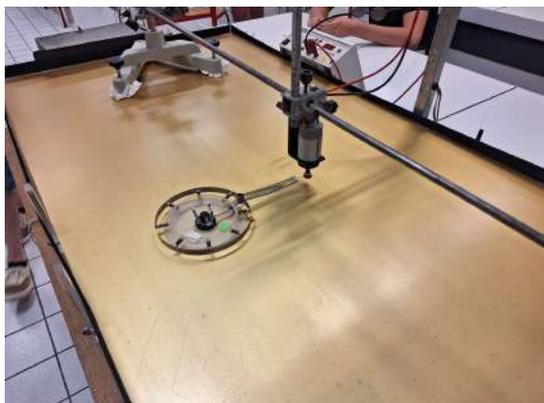
L'idée était de faire tourner différentes masses et de voir si la mesure de vitesse angulaire et l'allongement du ressort variaient et pouvait nous donner des informations sur la masse attachée.
