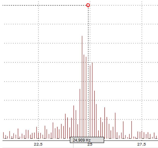
Transformée de Fourier du signal enregistré afin de vérifier la fiabilité du fréquencesmètre
