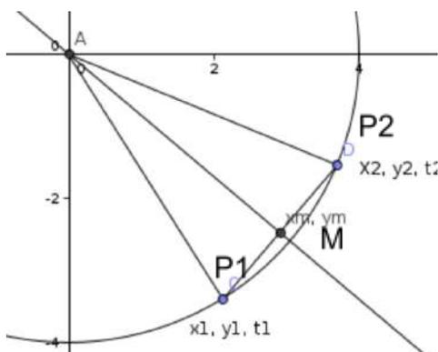
Soit l'image ci-contre une représentation théorique et simplifiée, avec une échelle arbitraire, d'une partie de notre expérience (avec A le centre du cercle formé par la trajectoire du mobile). On considère deux positions (appelées  $P_1$  et  $P_2$ , et un point M milieu du segment formé par  $P_1$  et  $P_2$ ) du mobile.
