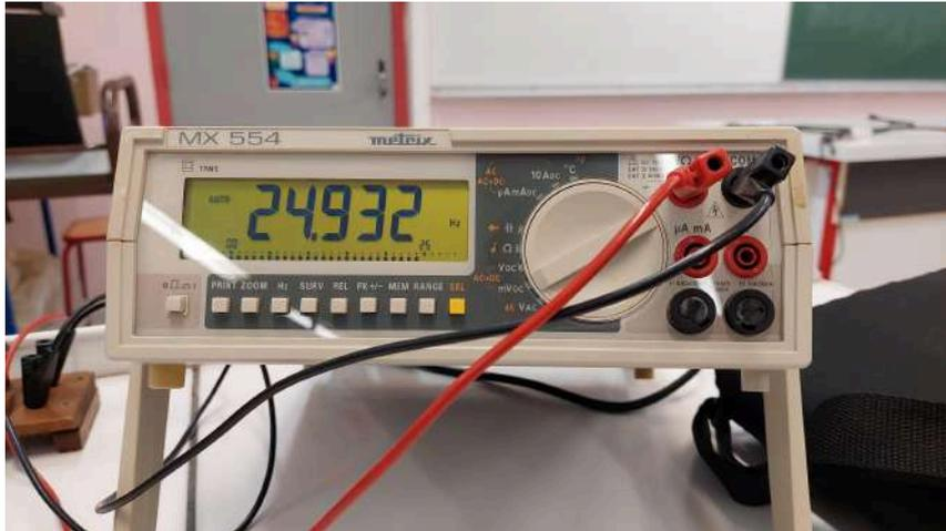
*Mesure d'une fréquence avec le fréquencemètre (dans le cadre d'une expérience)*
