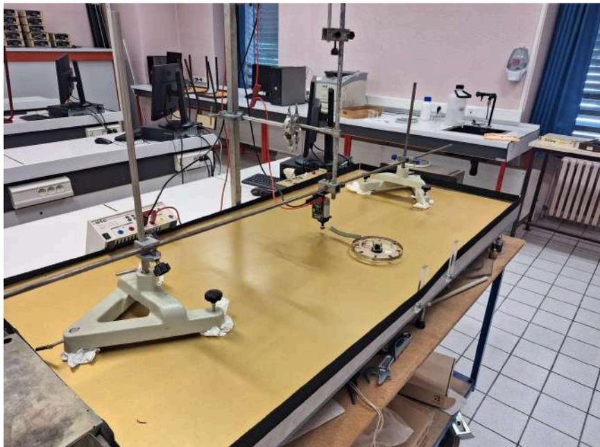
Il est composé d'une table à coussin d'air, d'un mobile relié à un moteur électrique par un ressort, le tout solidement agencé à l'aide de potences et diverses pinces. Le moteur électrique est alimenté par un générateur.
